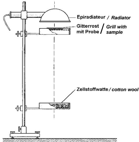
Abb. 2: Prüfaufbau zur Bestimmung des Tropfverhaltens
