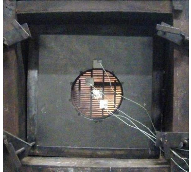
Abb. 6: Einbaubeispiel DIN 4102-8
