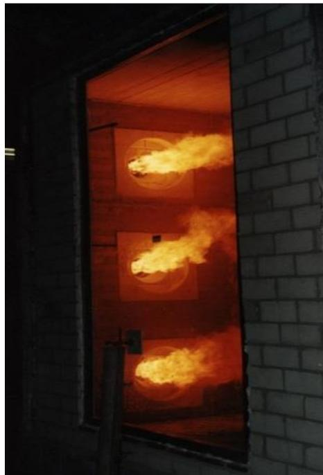
Abb 3: Prüfkammer mit aktiven Brennern
