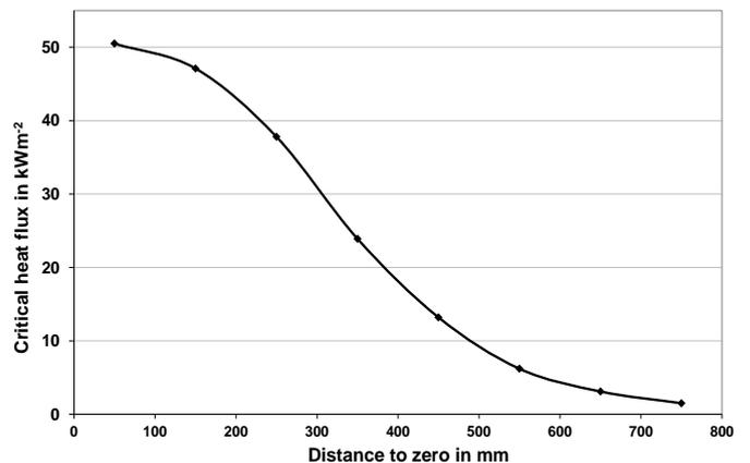
Abbildung 2: Strahlungsprofil auf dem Prüfkörper nach ISO 5658-2
