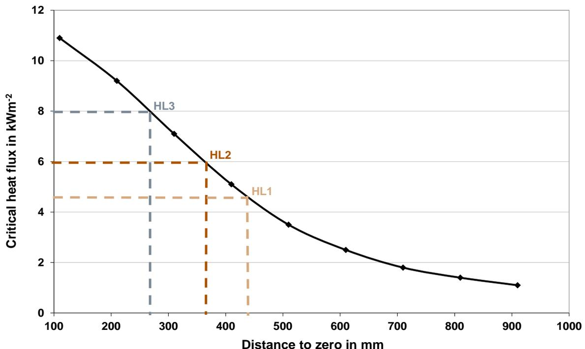
Abbildung 2: Strahlungsprofil und Gefährdungsstufen nach DIN EN ISO 9239-1
