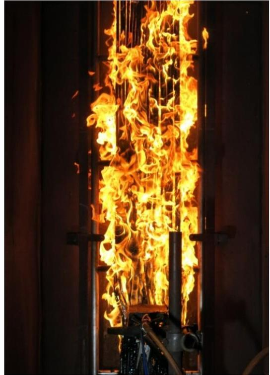
Abbildung 3: Prüfung der senkrechten Flammenausbreitung
