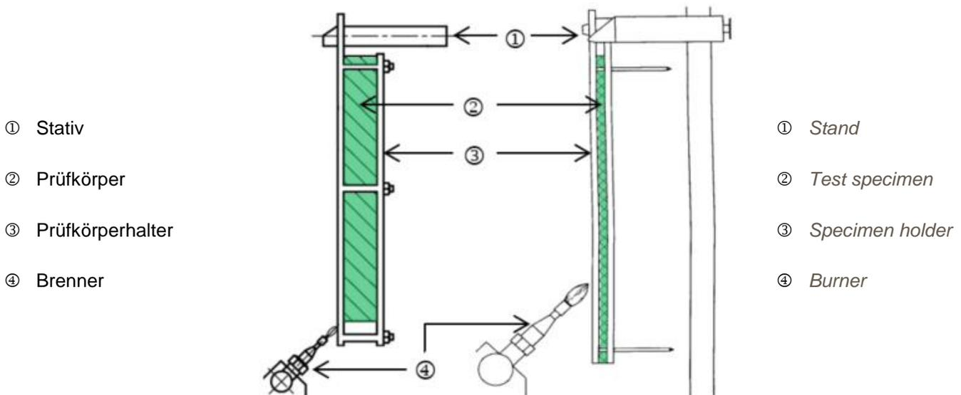
Abb. 1: Kanten- und Flächenbeflammung
