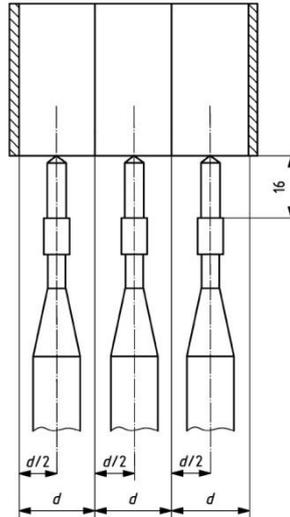
Abb.3: Beflammungsstellen bei mehrschichtigen
