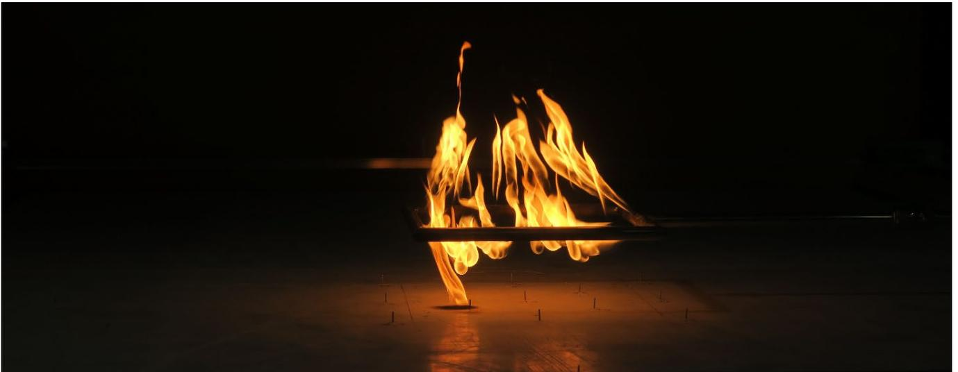
Abb. 2: Gasbrenner entsprechend der CLC/TR 50670
