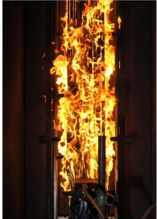
Abbildung 3: Prüfung der senkrechten Flammenausbreitung
